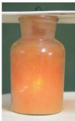
Hình 21.5. Chlorine tác dụng với dây sắt (iron) ở nhiệt độ cao
