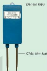
Hình 11.3. Dụng cụ thử tính dẫn điện
